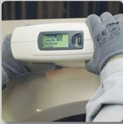
2. Farbton messen mit elektronischem Farbton-Messgerät Genius+
