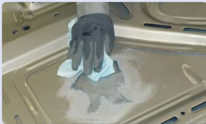
2. Reinigen mit Standox Silikonentferner
