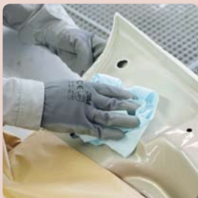
6. Reinigen mit Standox Silikonentferner
