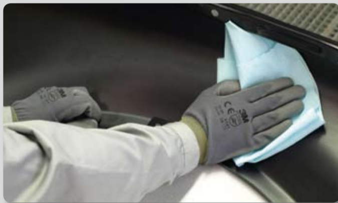
2. Reinigen mit Standox Silikonentferner
