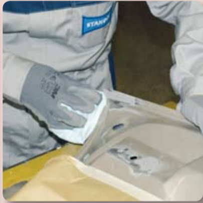
2. Reinigen mit Standox Silikonentferner
