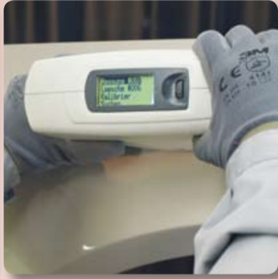
2. Farbton messen mit elektronischem Farbton-Messgerät Genius+
