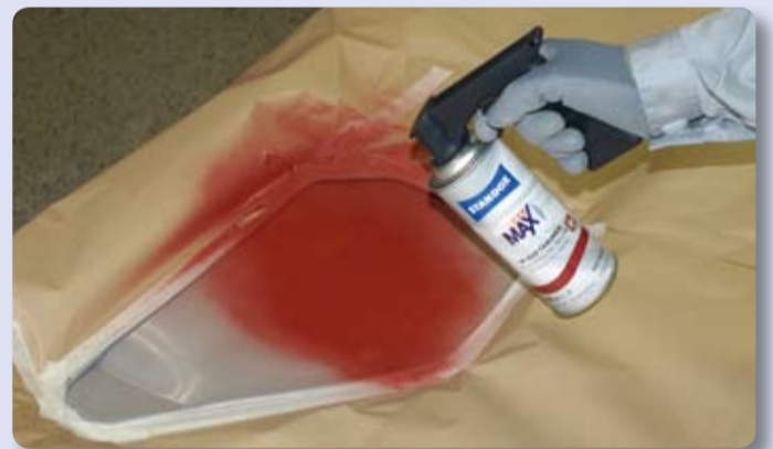
3. Standox 1K-Haftprimer rotbraun auftragen, zertifiziert als „Schweißgrund“
