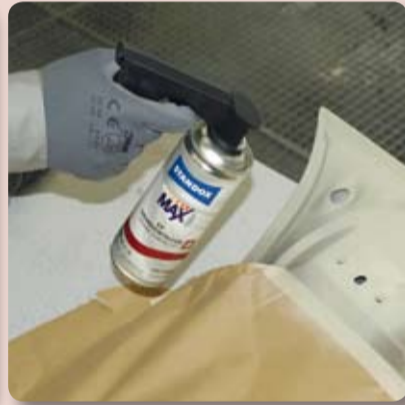
3. Standox 2K-EP-Grundierfüller auftragen
