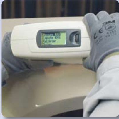
2. Farbton messen mit elektronischem Farbton-Messgerät Genius+
